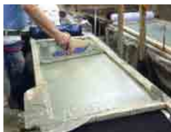
型付 型紙を枠に貼り、型台の上に伸ばした生地の上に防染糊をへらで付けていきます。年季のいる仕事です。
