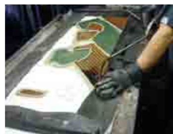
染色 防染糊で囲った部分に染料を注ぎます。足元のペダルを踏むとコンプレッサーで減圧され、染料が下の生地までいきわたります。
